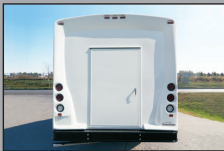
Capot stylé en fibres de verre avec porte d'accès arrière aux bagages
